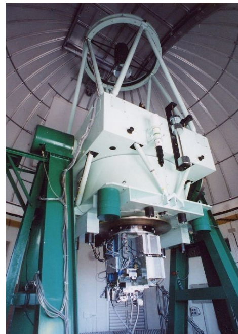
図 1 観測に使用した I R S F 望遠鏡と近赤外線カメラ SIRIUS
