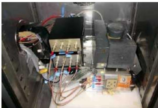
図 3 : 5 チャンネルの BGO 結晶を APD で読み出したシステムを恒温槽に納めた写真。ここには、検出器を納めた構造体と 4 チャンネル CSA 2 台が写っている。波形成型器と ADC ボードは恒温槽の外に設置した。
