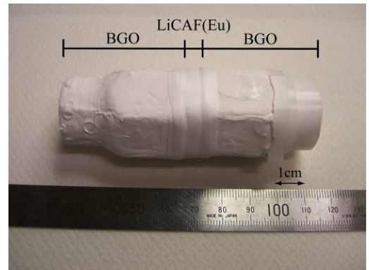
開発した中性子検出器。地上で動作検証した後、PoGOLite 気球に搭載済み。
