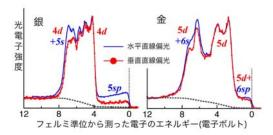
(3) 低温で微小ギャップが開くと考えられている強相関絶縁体 Sm<sub>1-x</sub>Eu<sub>x</sub>B<sub>6</sub>及び Yb<sub>1-x</sub>Lu<sub>x</sub>B<sub>12</sub>について極低エネルギー光電子分光及び硬 X線光電子分光を行った。前者では強相関 4f電子と混成するフェルミ準位近傍の価電子帯に数〜10 meV スケールのギャップが形成している過程の観測に成功した。後者ではフェルミ準位近傍の 4f スペクトル関数とその温度依存性が明確になった。従来この両者は気度のギャップ形成機構を持つ前提でよく議論されてきたがスペクトルのx及び温度依存性は明瞭に異なり、ギャップ形成機構が両者で異なることが判明した。
