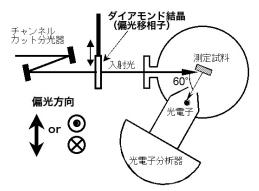
以上の実験環境を整備して、硬 X 線光電子スペクトルの偏光依存性を測定する。光電子の方向と電場ベクトルが垂直の配置(垂直配置)では全ての光電子強度が減少(s 電子がより劇的に減少)する。この為現在の測定(水平直線偏光利用、以後水平配置と呼ぶ)よりも3-5 倍程度の時間はかかるが、垂直配置の測定も十分可能で実現性に問題なかった。一方でチャンネルカット分光器を当時の Si(444) や Si(551)だけでなく Si(440)等も用いて、光の分解能を落とす代わりに強度を稼いで実験を行った。
