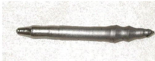
図 1: 引き上げ法により合成された UCoGe 単結晶試料。
