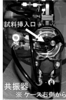
【図3】 本研究で組み上げた仮システム(上図)。磁気シールドケース内に空洞共振器を設置している(左図)。
