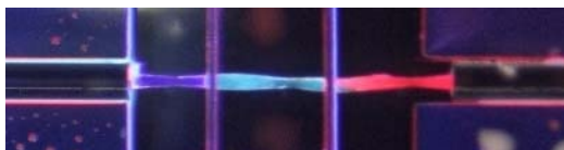
図8 3つの波長帯で発光する SWA 導波路の直列接続構造
