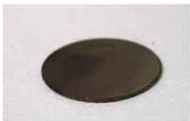
図 6. MSA 修飾金ナノ粒子粉末を 600 \text{ kg/cm}^2 の圧力で直径 1.3 cm、厚さ 0.4 mm に押し固めた試料。
