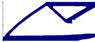
図7 トポロジー最適化の最適形状
