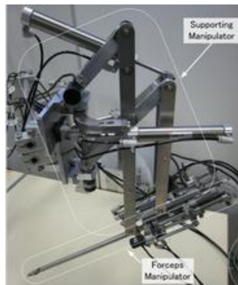
図 1 開発した空気圧駆動鉗子マニピュレータ IBIS IV
