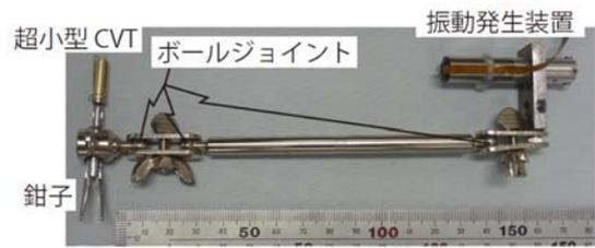
図 14: 3 次元空間に動力を伝達できる構造体
