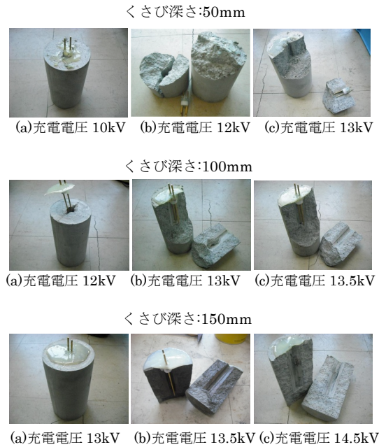
図 7. くさび入り試験片(Φ100, t=200)の破砕状況
