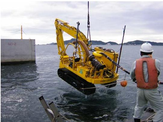
図-2 水中建設機械の遠隔操作作業実験
