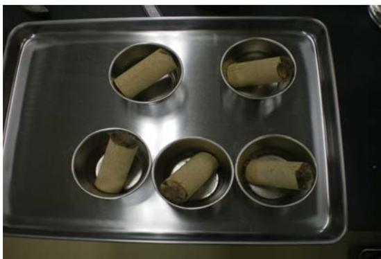
図-2 豊浦砂を固化した例
