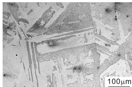
図 2 Fe-23Ni 合金におけるマルテンサイト組織の光学顕微鏡写真
