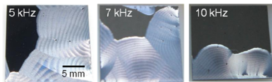
図5 スパッタ a-Si 膜を前駆体にして形成した poly-Si 膜の表面写真。分散パルスの周期を系統的に変化させている。
