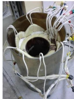
図 2. 二軸移動磁界攪拌装置の外観
