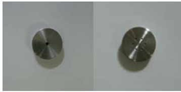
図9 製作したエジェクタ (左：1穴（単孔）、右：6穴（多孔）)
