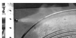
図 2 作動中の SOHLA-2 推進系
