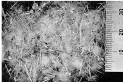
図1 廃 GFRP 破砕片
