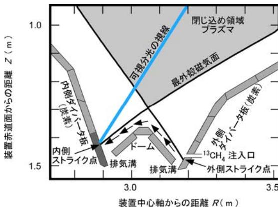
図 1. JT-60U のダイバータ領域のポロイダル断面での拡大図。濃い色で塗りつぶしたタイルを分析した。
