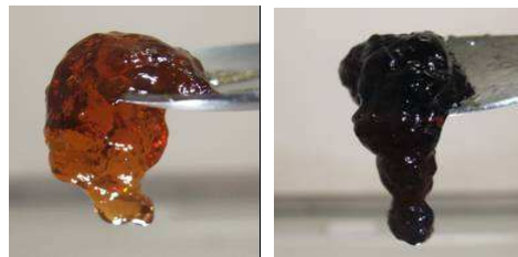
図3 linked-LSANa(左)および linked-LSA(H) (右) を用いて調製した化学架橋ゲルの外観
