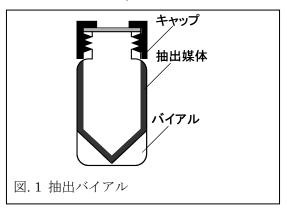
本研究の目的は、新規のクロマトグラフィ 一用試料前処理法であるバイアル抽出法を 開発することである。本研究で開発するバイ アル抽出法の分析プロトコールの概要を図 2 に示す。
