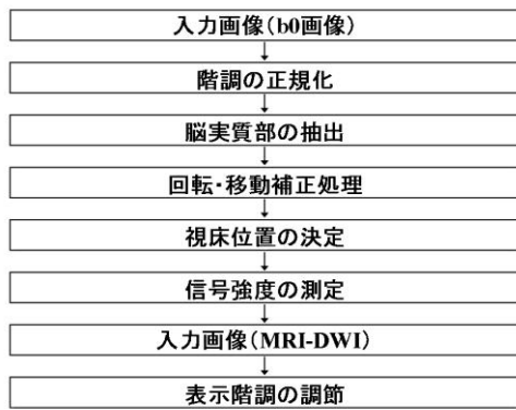
図1 ASIST-Japan の考案方法を自動化させた MRI-DWI における表示階調自動調節手法の概要
