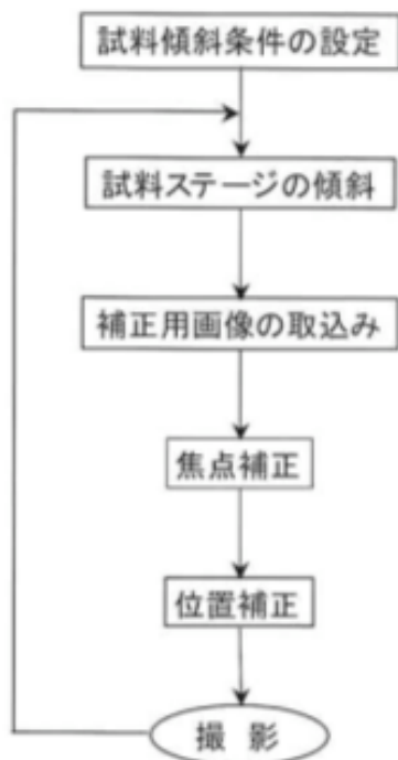
自動試料傾斜機能による連続傾斜像取得のフローチャート
