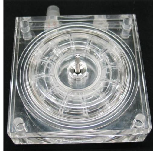
図 3：試作した構造決定モデルのポンプ
