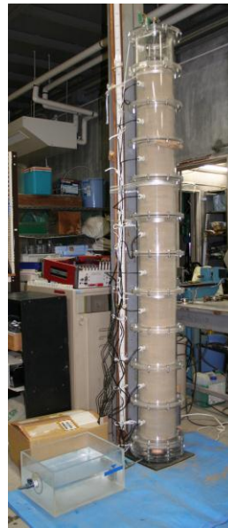
写真-1 不飽和浸透試験装置
