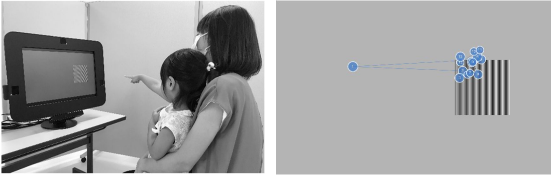
図1 視線解析装置（アイトラッカー）による縞視力測定
