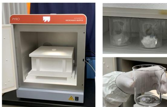
図 1 灰化装置および灰化前後の試料の様子
