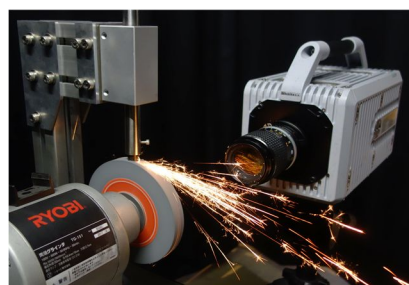
図1 実験装置：金属液滴発生装置と高速度カメラ
