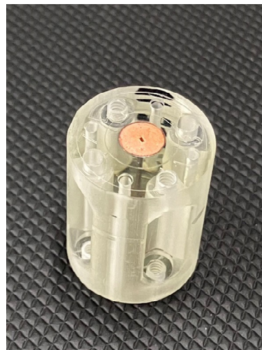
図 2 RECILS で造形し、中空部および両端のフランジにめっき膜を形成した WR-3 導波管
