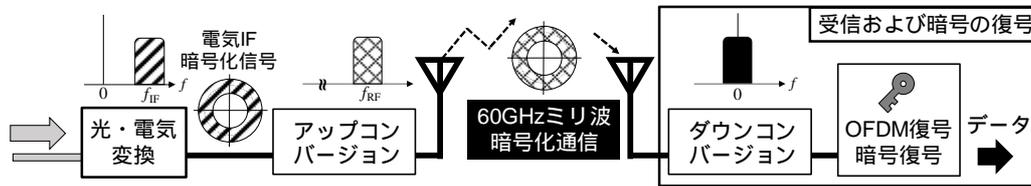
図 5. 物理レイヤ暗号化 OFDM 信号のミリ波無線伝送実験の構成
