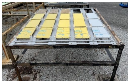
図 6 表面補修後の暴露試験体設置状況
