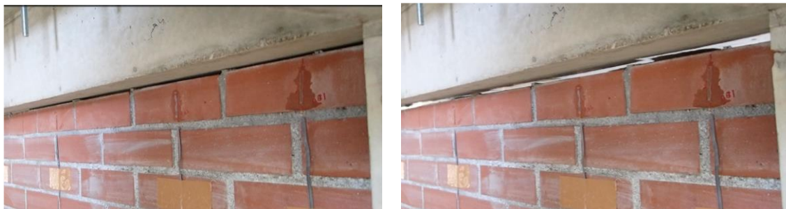
図 8 Specimen3 の 150%(2 回目)加振前(左)と加振後(右)の壁と梁の境界部の比較
