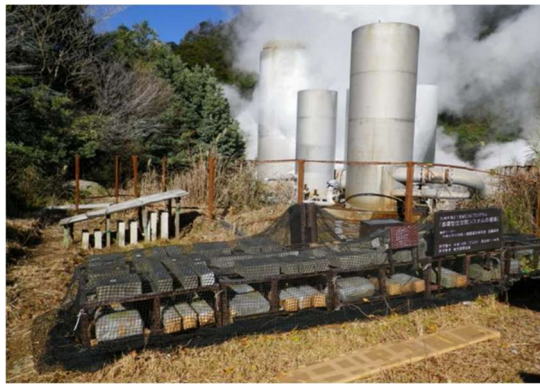
図 4-3-1 弱酸性の硫酸環境における暴露実験の状況(左)と試験体の劣化状況(右)
