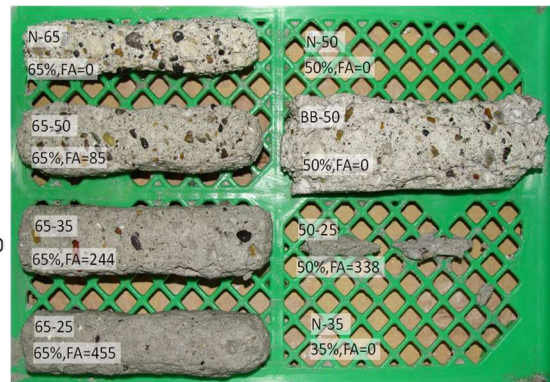
図 4-3-3 強酸性の硫酸環境における劣化状況
