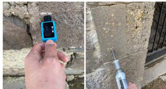
図 8 材料強度試験（リープ式及びシュミットハンマー）
