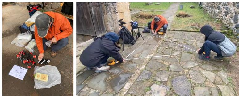
図 9 微動アレイ探査の様子
