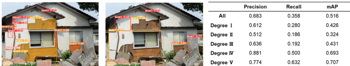
図4 損傷枠統合前（左）と統合後（右）の検出結果、およびその精度
