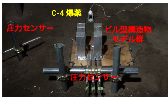
図2 ビル型構造物モデル群前後の圧力計測実験の例
