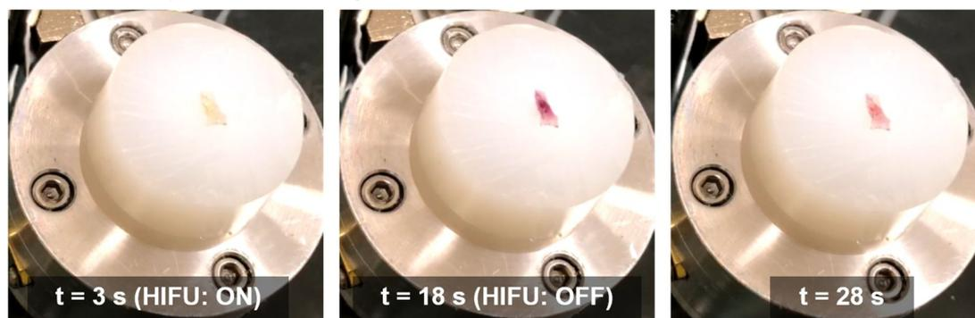
図 5. HABI を含む網目状 PDMS への HIFU 照射によって生じた試料の色変化
