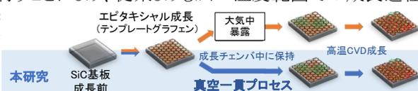
図5: 真空一貫プロセスによるテンプレートおよびCVD成長グラフェン形成
