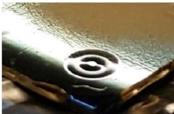
図 2: 零熱膨張ガラスで作った3次元振動子
