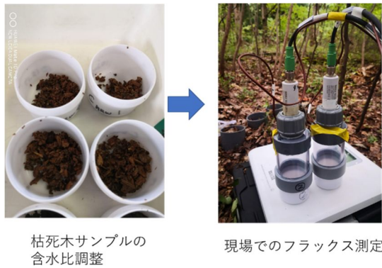
図 2 小型 IRGA を用いた SIR 法測定
