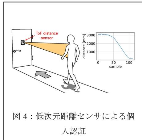
図 4 : 低次元距離センサによる個人認証
