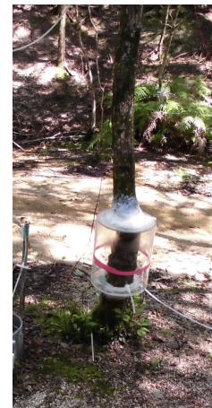
図1 ハンノキの幹からメタンが発生する量を測定するために、チャンバーを取り付けた様子。
