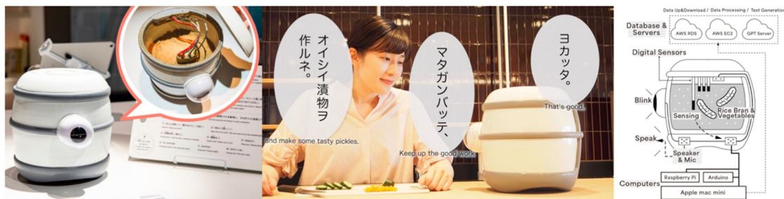
図. (左) Nukabot の外観と中身 (中央) Nukabot の動作説明映像 (右) 第 4 世代 Nukabot のシステム図
