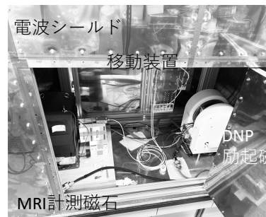
図 開発機の外観 DNP 励起 20mT、MRI 計測 1T、移動装置が電波シールド内に設置
