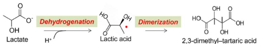
図2 化学反応スキーム。乳酸から C 中心ラジカルの生成を介した二量体化による酒石酸ジメチルの生成反応経路 ( Y. Liu, K. Ishikawa, et al., Plasma Process Polym. 20, 2200193 (2023). )
