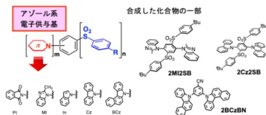
図 6 導入したアゾール系電子供与基と合成した化合物の構造式。
