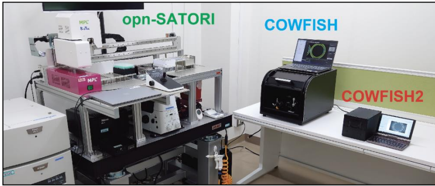
図2 SATORI法を実装した検査装置
