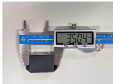
図 2. 開発した 6 軸加速度センサー 重量 20g であり、マーモセットが装着可能なサイズで開発した。
