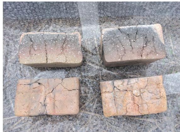
図6 実験製作焼成粘土塊断面
